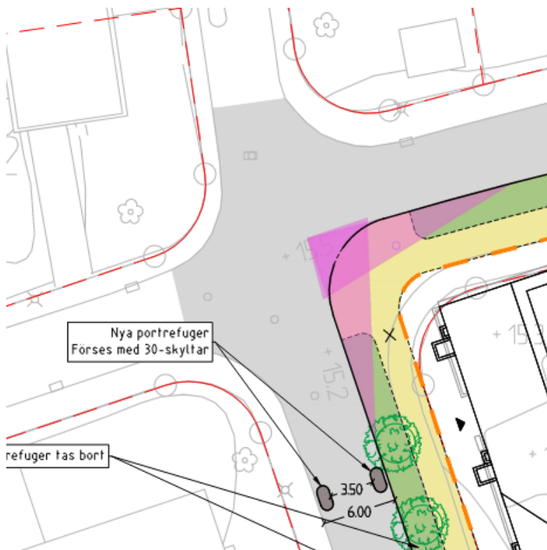
Figur 9 - Siktriangler vid korsningen mellan Frimästaregatan och Fjällbogatan
